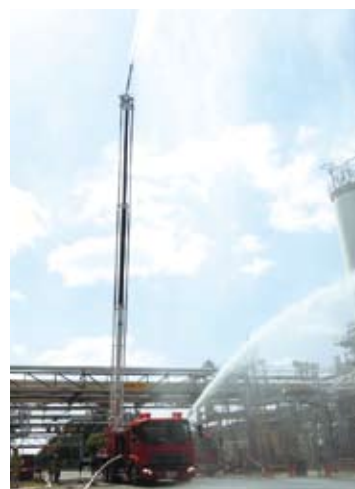
大型化学高所放水車と 甲種普通化学消防車による放水訓練
