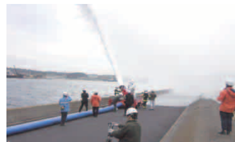
配備された大容量泡放水砲の実射試験状況
