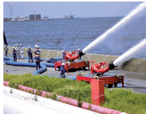
大容量泡放射システムによる実放射訓練
