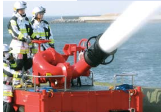
搬送・設置された 大容量泡放射システムによる実放射
