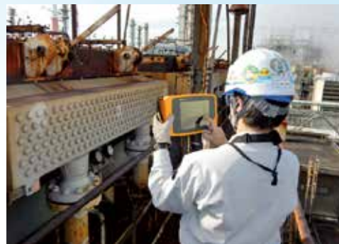
気密テストにおける超音波カメラの活用
